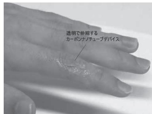
図2. カーボンナノチューブを用いて開発したストレッチャブルデバイス。
