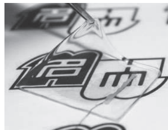
図 2. 作製した摩擦帯電型発電シート.
