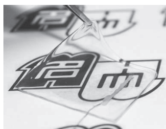
図 2, 作製した摩擦帯電型発電シート.
