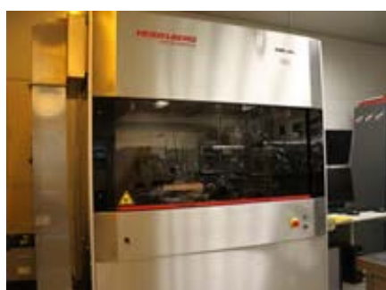
レーザーリソグラフィ装置
