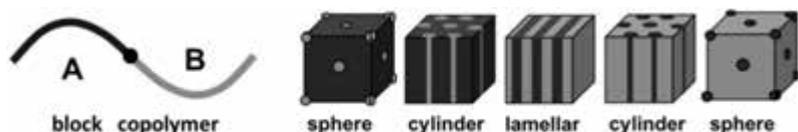
図1 ジブロックコポリマーとマイクロ相分離構造
