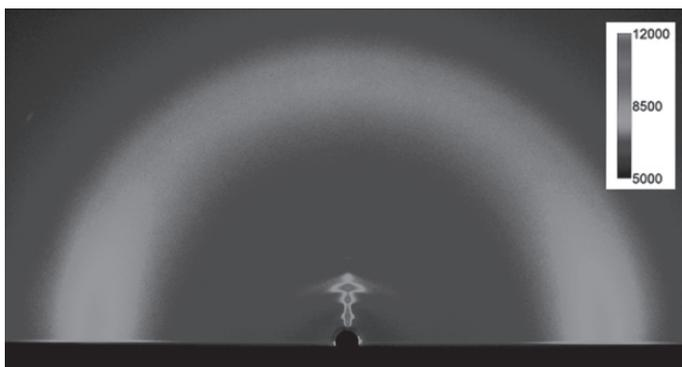
図1 高分子液晶薄膜の斜入射 X 線散乱像
