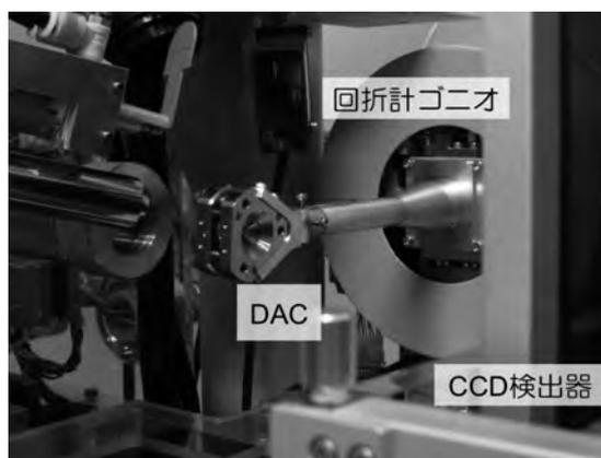
図1. 蛋白質単結晶用 DAC を NW12A の回折計に搭載した写真。
