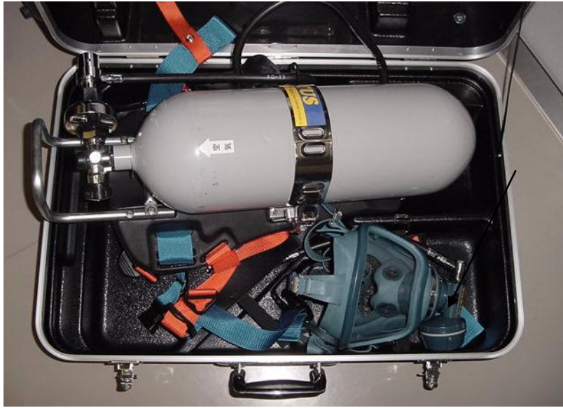
空気呼吸器（前室に常設）
