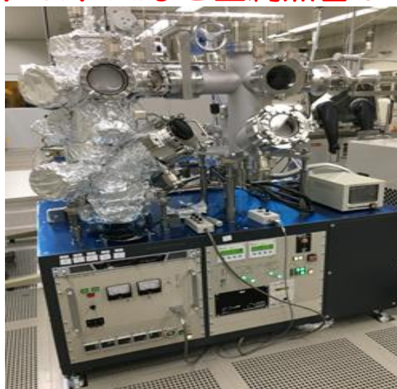
高真空電子線ビーム蒸着装置 ：蒸発面に対して基板が \pm 90^\circ 回転 するので傾斜蒸着が可能
