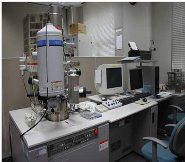
高分解能走査型電子顕微鏡
