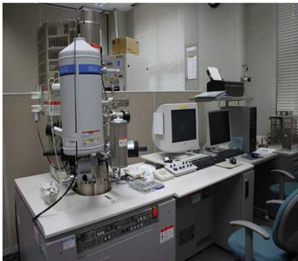
高分解能走査型電子顕微鏡
